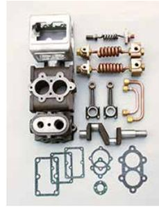
YSシリーズは、誰でも扱えるわかりやすい操作を基本理念として開発されました。システムの全体を徹底的にシンプル化していますので、運転状態が容易に把握でき、操作ミスを防じます。また、高圧部にセパレートピストンを採用。消耗する高圧部のピストンリングの交換は、シリンダー・コネクティングロッド等を取り外さずに行えるので、メンテナンスが段と容易です。さらに、保守管理に必要な部品はいつでも供給が可能です。
