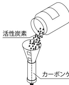
カーボンケース (JIS-S-7306 スクーバ用圧縮空気基準適合)
